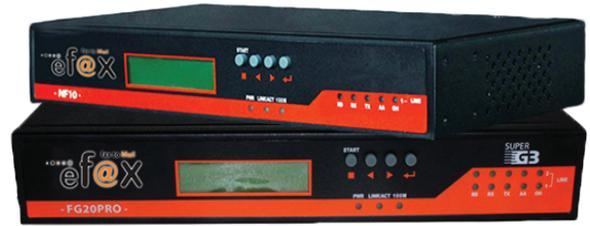
Le serveur de fax réseaux E-Fax a été conçu pour répondre aux besoins des PME et TPE. Le E-Fax est fourni avec les logiciels nécessaires pour permettre aux utilisateurs du réseau d'envoyer et de recevoir des fax depuis leurs postes de travail ou depuis un navigateur internet.
